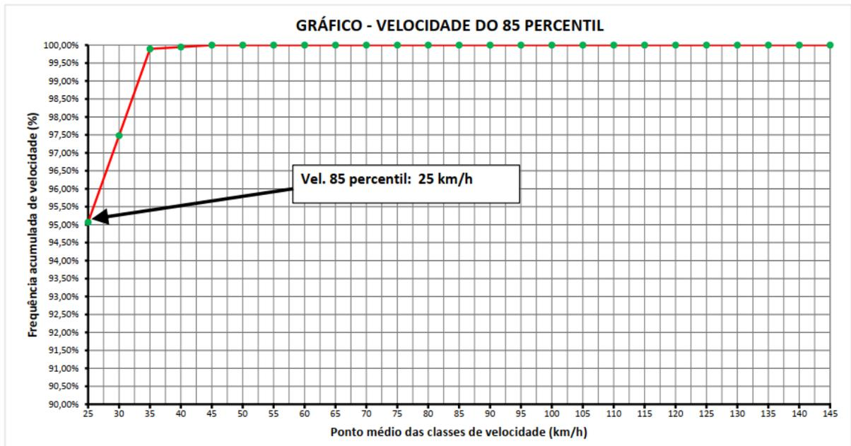
3.5.3 Tabulação de Velocidade para o Cálculo do 85 Percentil - Gráfico (frequência acumulada de velocidade (%) x ponto médio das classes de velocidade (km/h):
